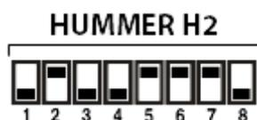
В системе предусмотрена возможность оперативного изменения 4 параметров при помощи DIP-переключателей SW2. Каждому параметру соответствует отдельный переключатель. :
